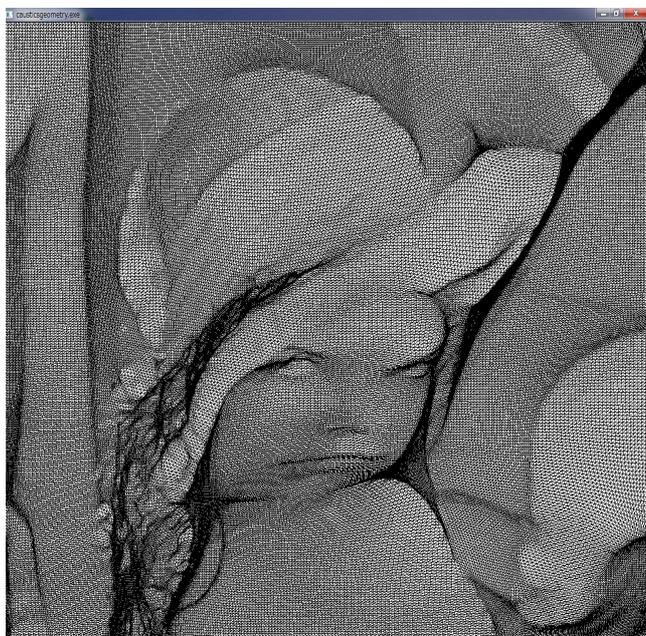
図 6. 図 5(e)のパラメータ化のメッシュ表示の拡大図. 集光模様で輝度が高い部分に相当する領域ではメッシュ間隔が広い. このため, より広い領域からの光がスクリーン上に集まり, 集光模様の輝度が高くなる.
