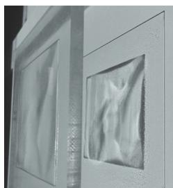
図10. NC機械により作製した透明物体(左)と、その集光模様(右).
